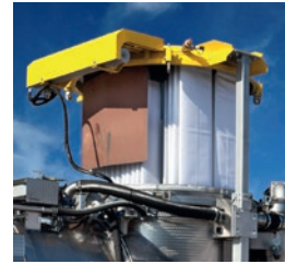
Trockensaugfilter mit Filterhubsystem
