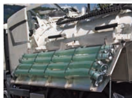
Support tube, dépliant hydrauliquement par radio
