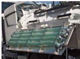
Rrohrhalterung, hydraulisch per Funk ausklappbar
