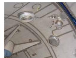
Capteur niveau de remplissage
