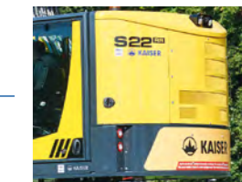
Pelle rail-route innovante en version non-profilée (rayon d'orientation arrière < 1.57 m).
