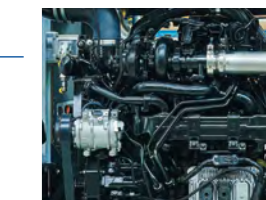
Moteur diesel puissant de 125 kW répondant aux normes antipollution niveau IV et CH LRV.
